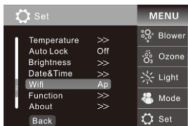
Lorsque l'émetteur-récepteur de wifi est en mode OFF, appuyez sur le bouton « ⊙ », le statut de wifi est affiché comme «Clean» et le statut s'affichera comme «AP» après quelques secondes, indiquant que la réinitialisation du mot de passe est réussie. Pour la méthode d'opération de connexion de Wifi, veuillez référencer instructions de SPA APP.
